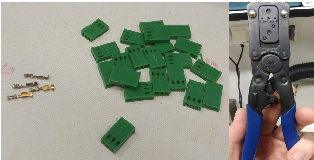
Fig 28. Connecteurs et pince pour sertissage
