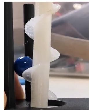
Grâce à un roulement à billes en haut de la vis, celle-ci pouvait tourner sans trop de frottement tout en restant bien droite. Cependant, la sortie de la bille de la vis sans fin n'était pas encore réglée. En effet, la bille, lorsqu'elle atteint le haut de la montée reste entre les 2 barres et se bloque. Une sortie incurvée a donc été collée par la suite en haut des tiges pour permettre aux billes de sortir de la vis sans fin.
