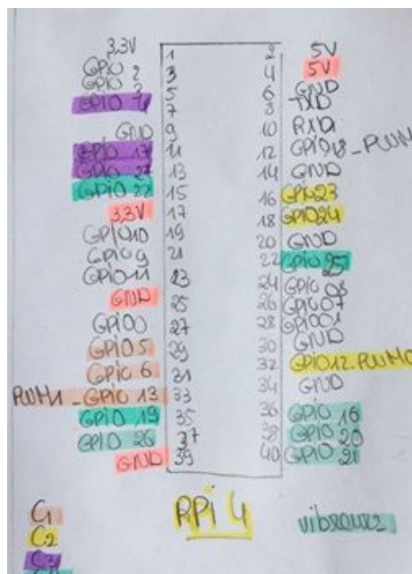
Schéma de l'attribution des GPIOs sur une Raspberry Pi 4
