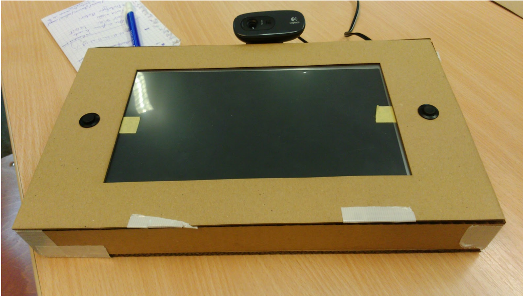
Figure 11 : Troisième prototype en carton dur réalisé à l'aide de la découpeuse LASER
