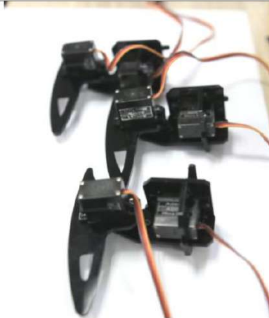
Montage final des pattes de gauche
