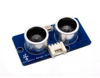
Un capteur à ultrasons émet de courtes impulsions sonores à haute fréquence. Ces impulsions se propagent dans l'air à la vitesse du son. Lorsqu'elles rencontrent un objet, elles se réfléchissent et reviennent sous forme d'écho au capteur. Celui-ci calcule alors la distance entre l'obstacle et le capteur par le temps de propagation des ultrasons grâce au temps écoulé entre l'émission du signal et la réception de l'écho.
