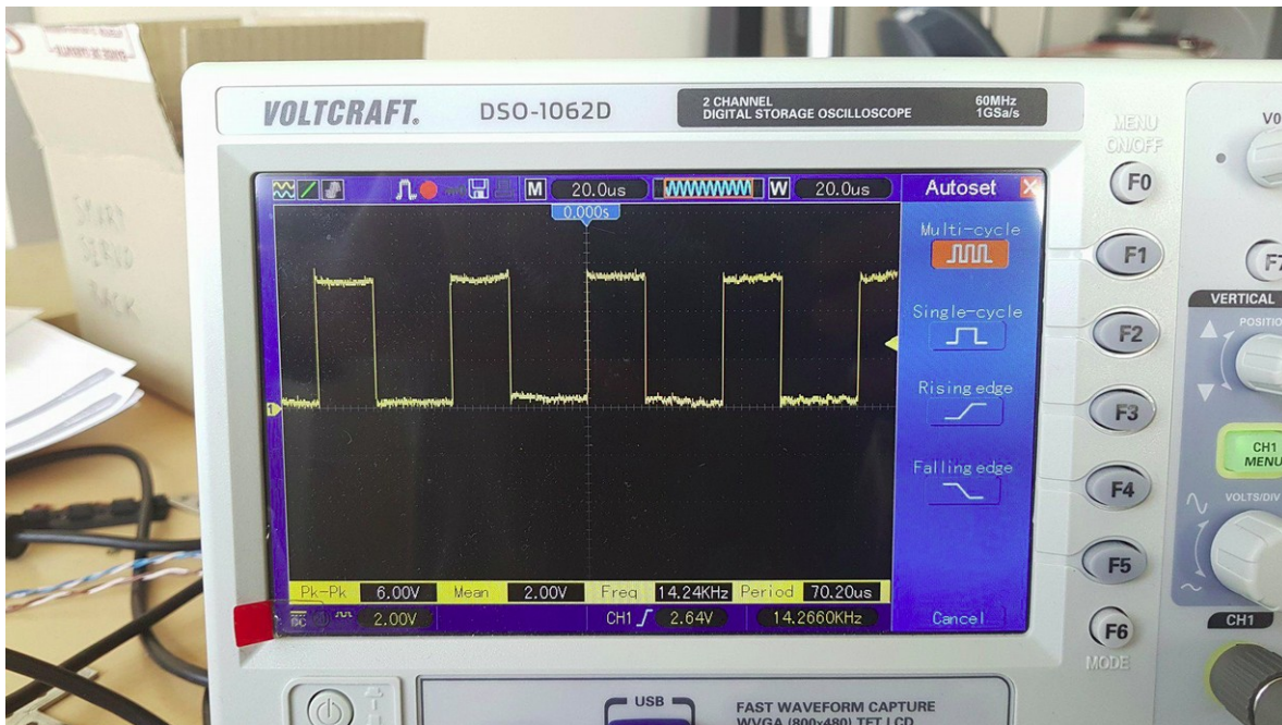
Photo 13: Signal PWM avec une période de 70 \mu s.
