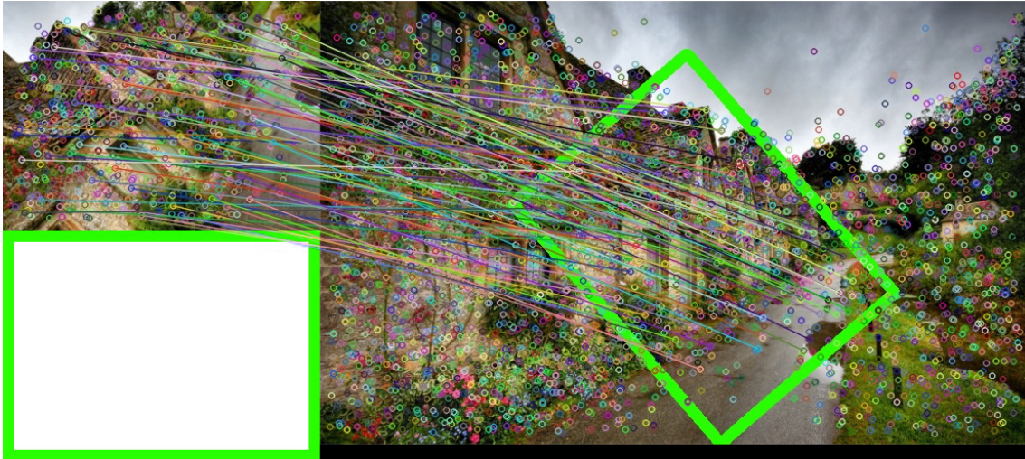
FIGURE 3.3 – Application du calque (en bas à gauche) à l'image par application de la matrice de transformation
