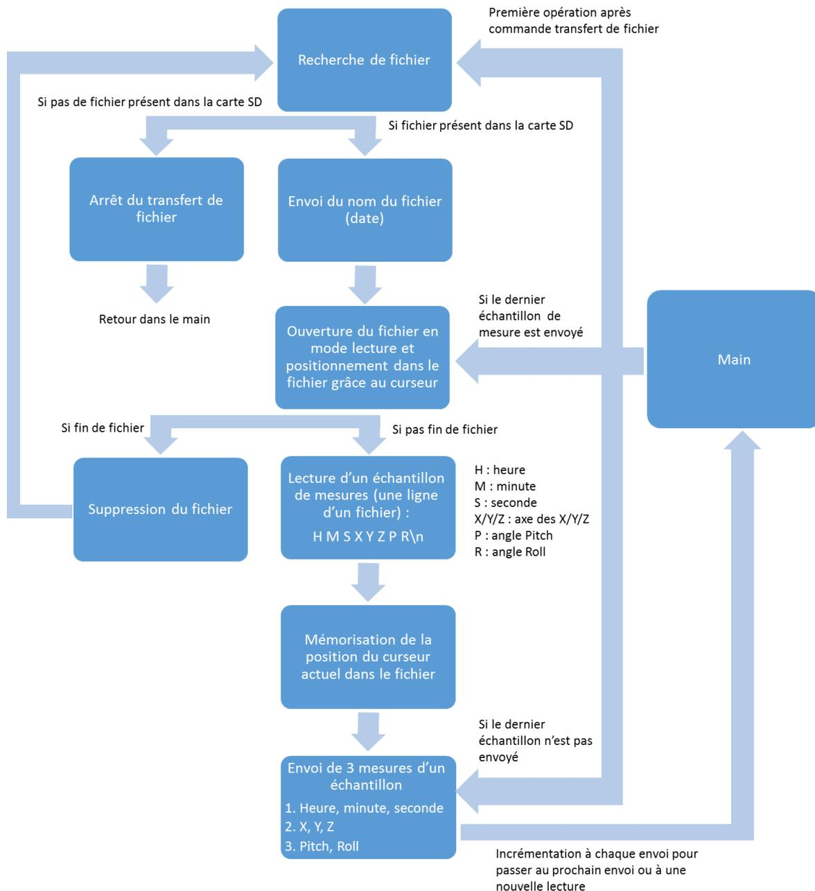
Pour rappel, chaque ligne correspond à un échantillon de mesure et se décompose de la manière suivante : Heure Minute Seconde AxeX AxeY AxeZ Pitch Roll.
