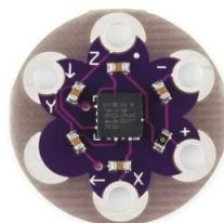
Cette shield est basé sur l'accéléromètre ADXL335 qui émet des signaux analogiques entre un 0V à 3V sur chacun des X, Y et Z axes. Pour avoir des mesures précises, nous convertissons cette tension analogique en une unité de gravité. A partir des règles de trigonométrie, nous récupérons les angles pitch et roll :
