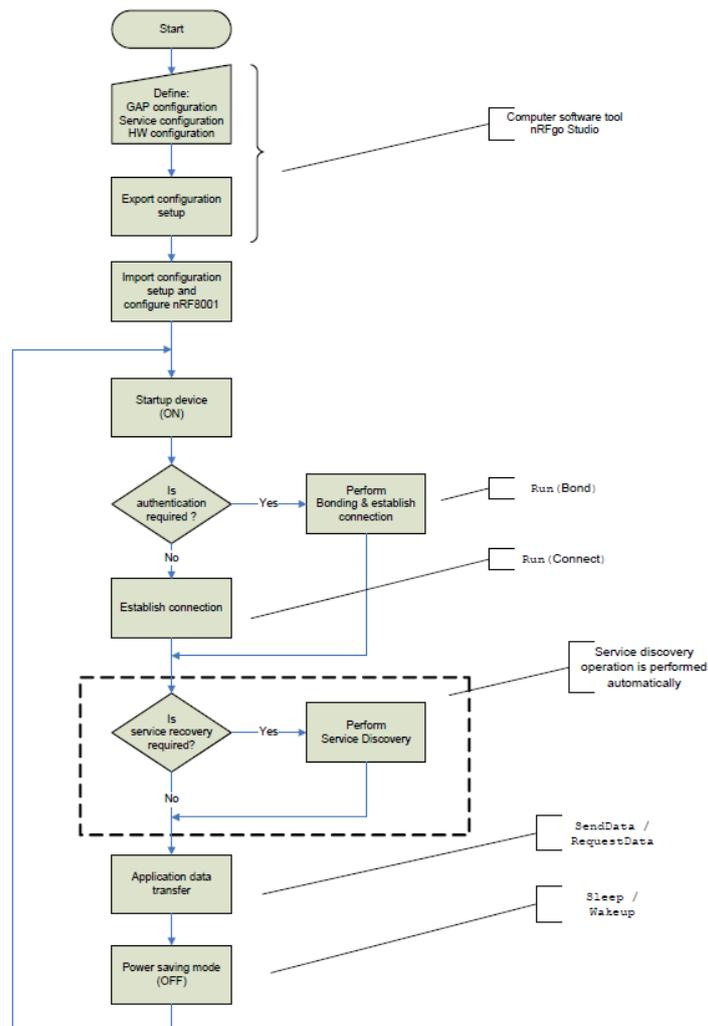
Pour communiquer avec le nRF8001, nous utilisons le protocole ACI (Application Controller Interface) qui utilise l'interface standard SPI pour échanger les données entre l'Arduino et le BLE.
