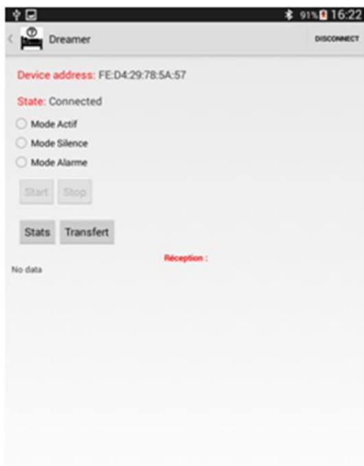
Nous accédons à l'interface de contrôle. Dans la barre de menu il est possible à tout moment de se connecter/déconnecter du capteur.
