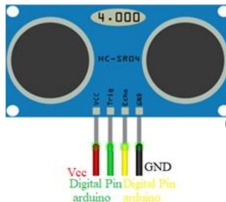
Le capteur de distance comporte un émetteur et un récepteur d'ondes qui sont représenté sur le schéma ci-dessus par les deux ronds noirs. L'émetteur envoie une onde, celle-ci se réfléchit sur l'obstacle et le récepteur reçoit donc un écho de l'onde émise par l'émetteur.
