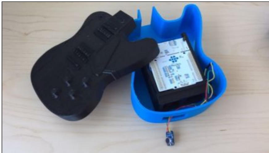
Boîtier final comprenant la carte Nucleo, et notre carte électronique en dessous
