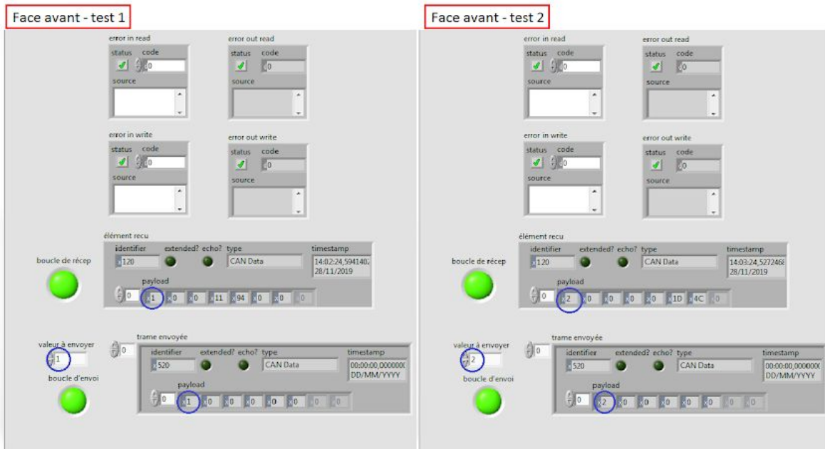
Figure A9. Face-avant Labview montrant la fonctionnalité d'envoi et réception simultanée de trames CAN
