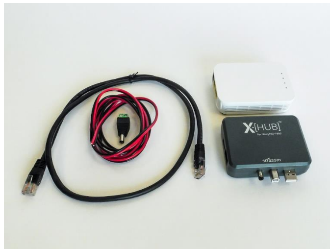
OM5P-A (Point d'accès sans fil blanc) et X-Hub (extension grise du myRIO)
