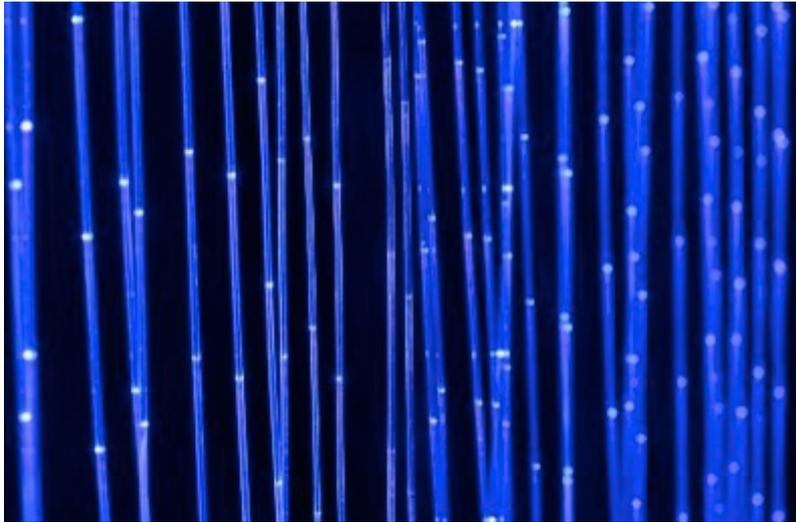
On a choisi les fibres optiques striées. c'est à dire avec des points lumineux tous les 2 cm le long de la fibre optique et possède un diamètre de 1mm. Au bout de ces fibres nous allons ajouter des kits de terminaisons trouvés sur le site sur lequel on a commandé les fibres optiques pour recueillir la lumière diffuse au bout des fibres.
