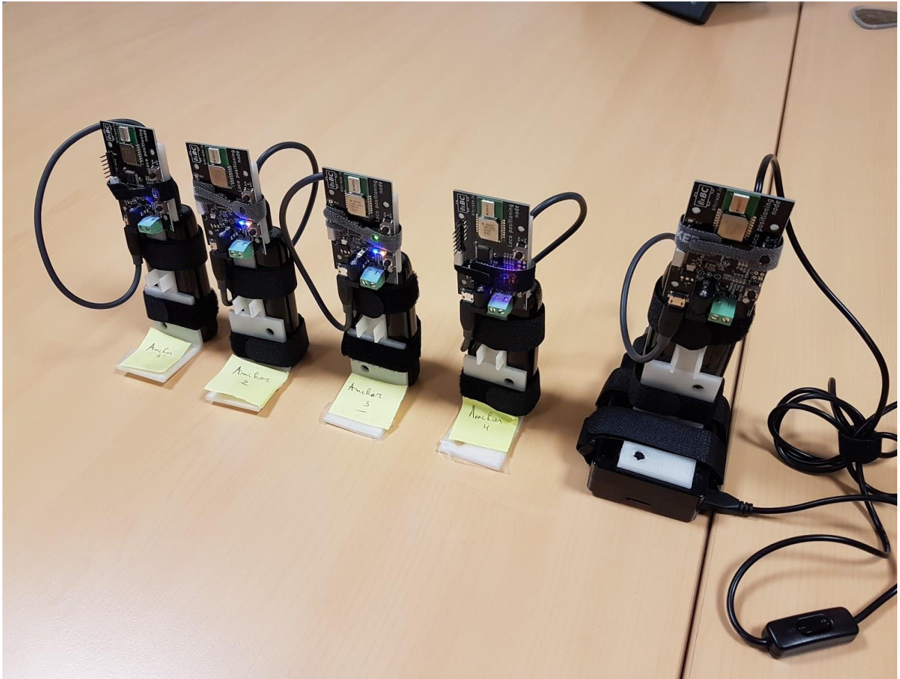
4 anchors et 1 tag connecté à une RPi3
