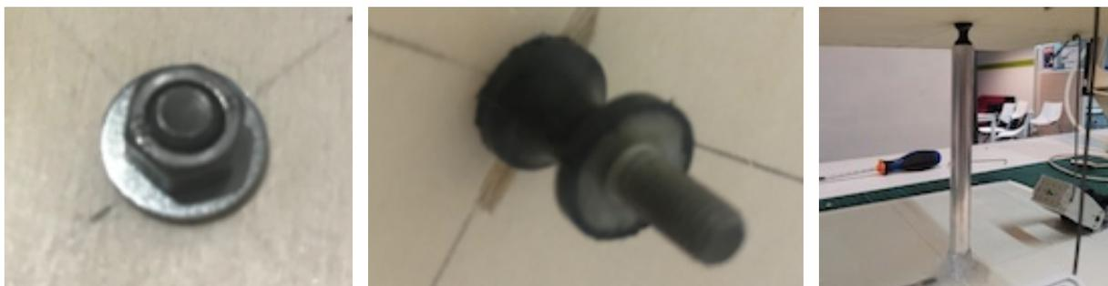
2. J'utilise les composants du servomoteur Bioloïd comme la bascule. Et ajouter du fil de fer au milieu. Pour pouvoir contrôler précisément l'inclinaison du labyrinthe, il faut limiter la zone de mouvement du fil, j'ai donc mis un anneau en plastique.
