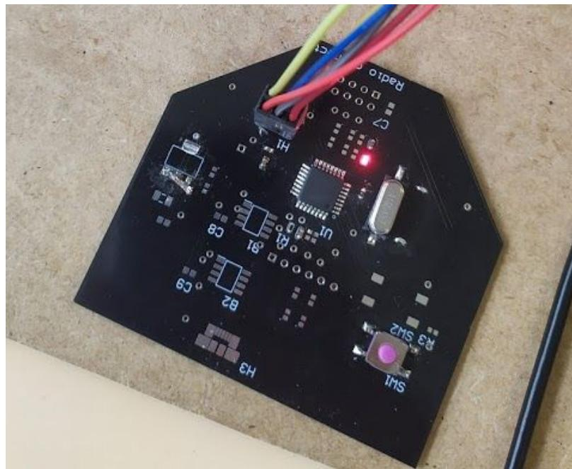
A l'aide d'un calculateur de fusible trouvé sur internet je choisis les différentes valeurs afin de permettre un fonctionnement à l'aide de la clock interne de 8 MHz. Il faut, pour cela, modifier les low fuses. Je choisis d'avoir un CK de +65ms, il s'agit du boottime maximum proposé par ce composant. Ce temps est prévu afin de laisser l'oscillateur osciller parfaitement. avant de démarrer.
