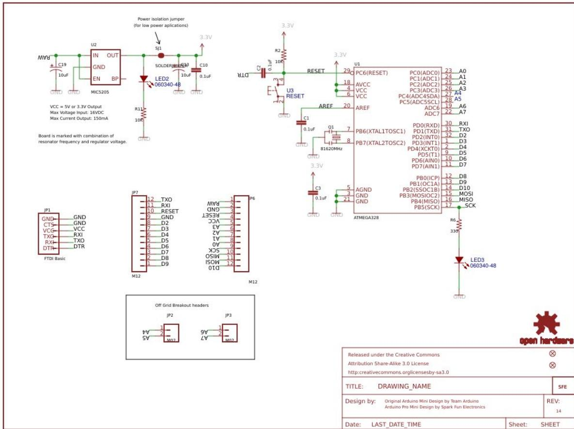
Pour permettre aux mémoires vives et au module NRF24L01 de fonctionner, il faut que leur tension d'alimentation soit de 3.3V maximum. Les signaux logiques les pilotant doivent également être de 3.3V. Ce qui signifie que l'Atmega328p doit impérativement fonctionner en 3.3V et donc nécessairement en 8MHz.
