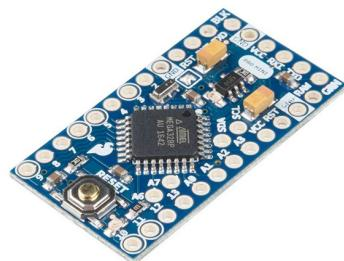
Cette carte sera constituée d'un atmega328p qui nous permet d'obtenir un espace de taille, à priori, suffisante afin de programmer le bootloader. Cependant, un microcontrôleur de taille supérieur aurait également pu être utilisé pour ce projet.
