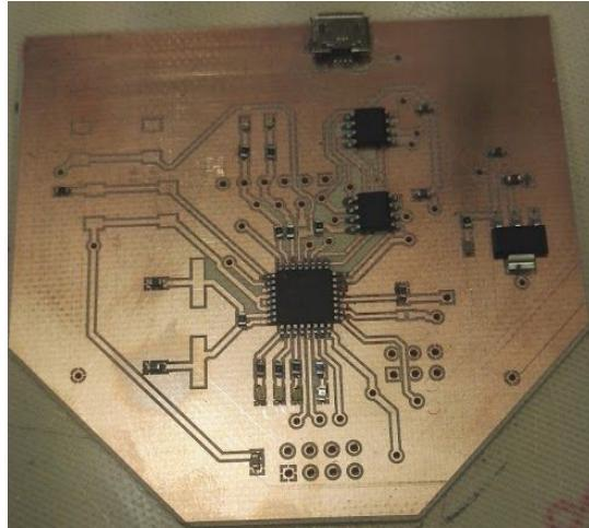
Une fois ces composants soudés, des tests grâce au multimètre en mode contacteur ont démontré que le port micro-usb était mal soudés. Un court-circuit était présent à l'arrière des pattes du composant. Dans l'impossibilité de supprimer ce court-circuit, j'ai décidé de supprimer cette prise qui n'était pas essentiel pour le début du projet.
