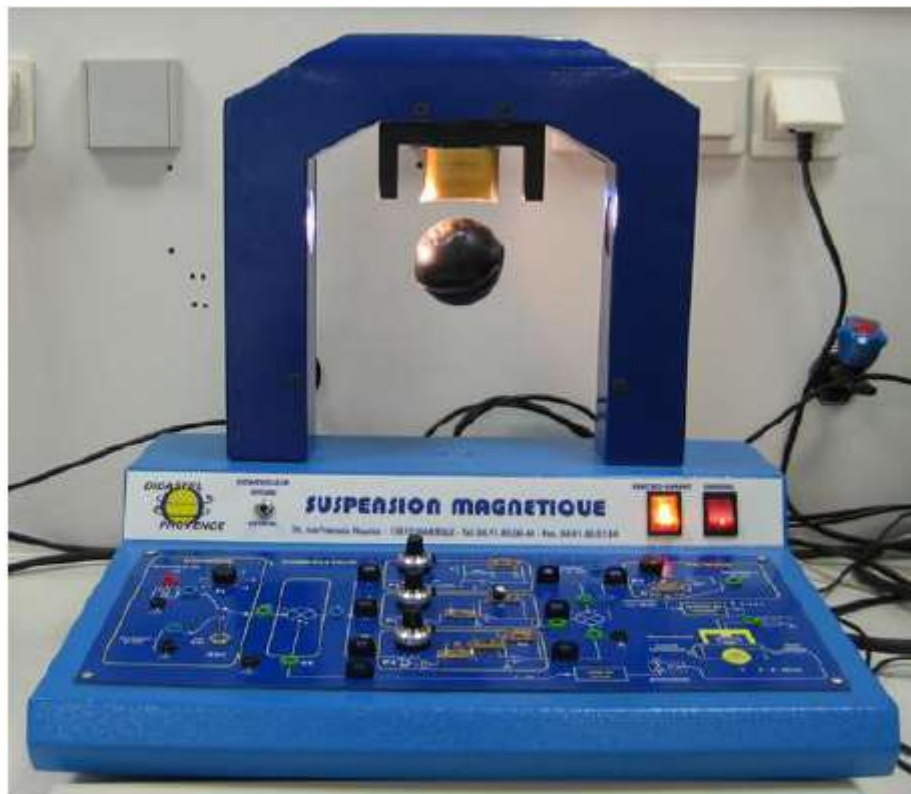
La suspension magnétique Didastel
