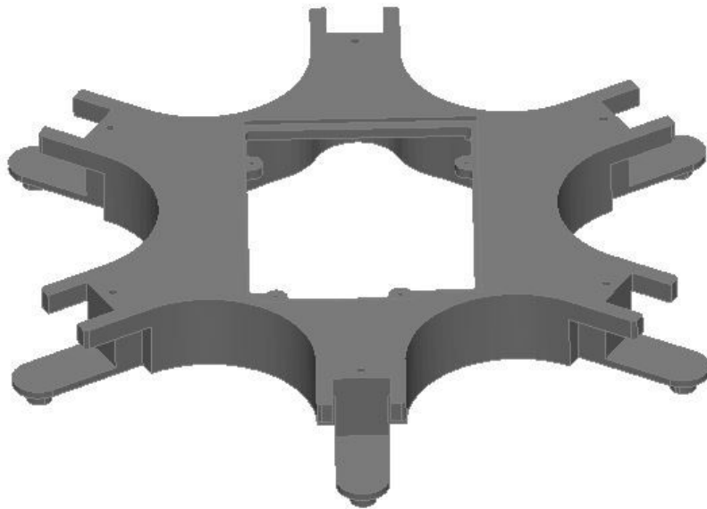
Figure 3 : Modélisation 3D du châssis
