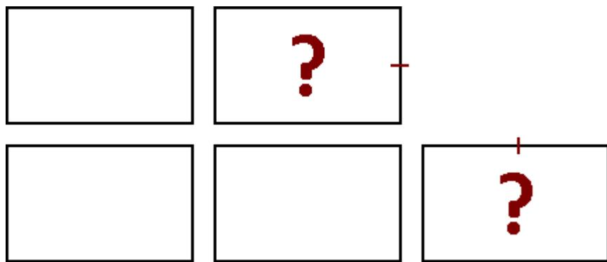
Dans cette configuration, les capteurs situés en haut et à droite des écrans indiqués feraient que ces écrans seraient considérés comme étant tous les deux en haut à droite d'une configuration, ainsi il deviendrait difficile - sans traitement plus élaboré - de déterminer leur véritable position en ne prenant en compte uniquement les capteurs.
