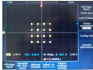
FIGURE A.1 – Constellation visualisée en mode X-Y.
