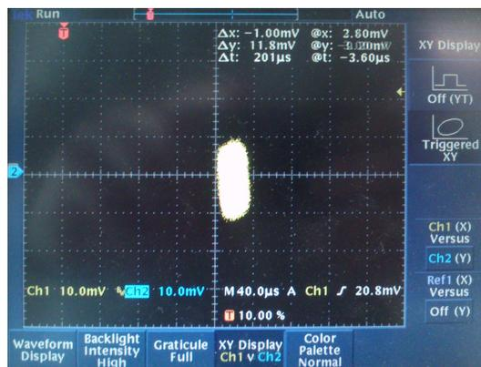
FIGURE A.15 – "Constellation" récupérée avec la PLL défectueuse (on souhaite se verrouiller sur la raie à 868MHz).
