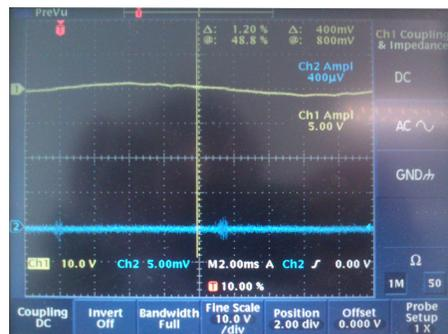
FIGURE A.12 – Chaîne 1 : V<sub>tune</sub> (commande du V.C.O.)/Chaîne 2 : "erreur" de commande
