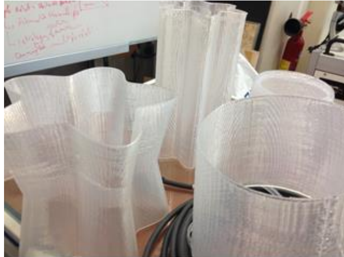
Figure 11 - Pièces imprimées en PS avec MatLab
