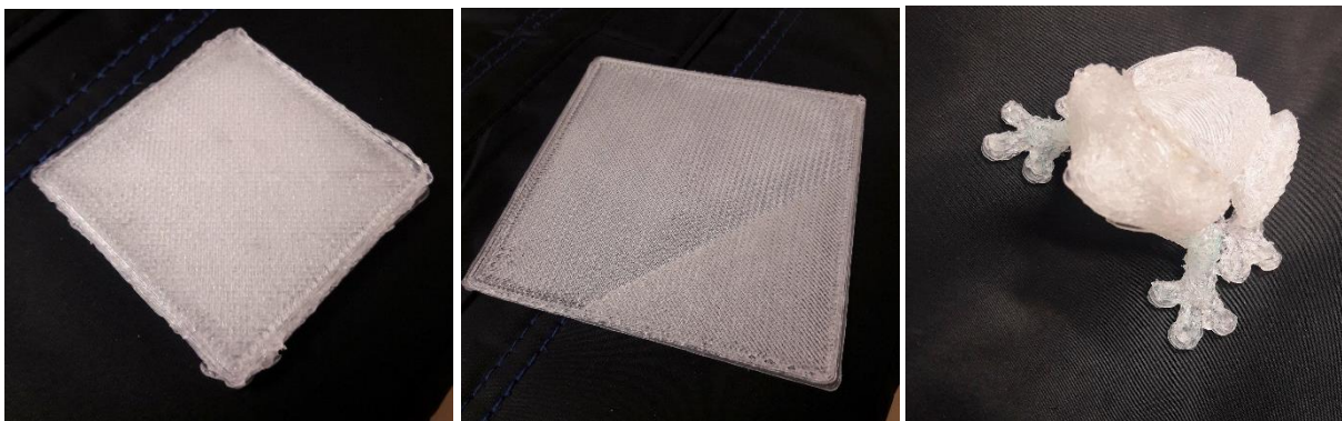
Figure 22 - Pièces avec remplissage et déportée convenables
