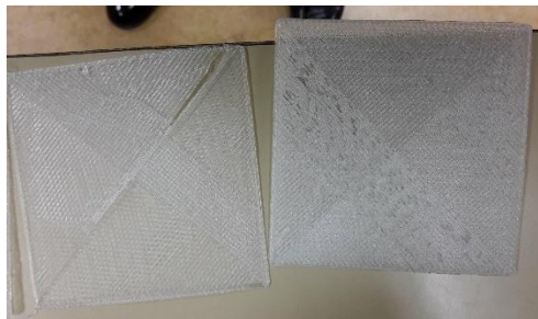
Figure 21 - Slicer CURA : Désolidarisation des pièces à la jointure centrale
