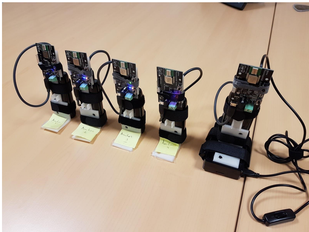
4 anchors et 1 tag connecté à une RPi3
